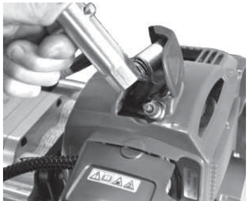
FIG. 9 SPARK PLUG CLEANING NETTOYAGE DE LA BOUGIE D'ALLUMAGE REINIGUNG DER ZÜNDKERZE LIMPIEZA DE LA BUJIA DE ENCENDIDO PULIZIA DELLA CANDELA D'ACCENSIONE
