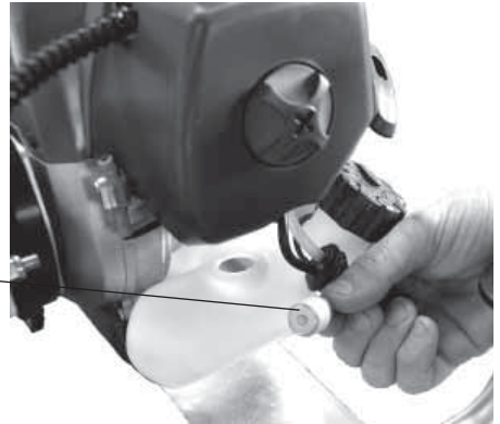
FIG. 7 FUEL FILTER CLEANING NETTOYAGE FILTRE ESSENCE REINIGUNG KRAFTSTOFFFILTER LIMPIEZA FILTRO MEZCLA PULIZIA DEL FILTRO MISCELA
